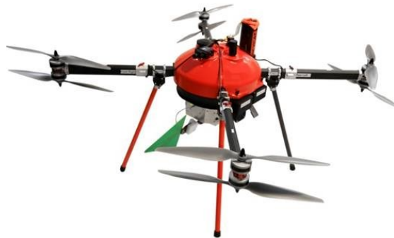
Figura 8. Drone Colibrex, hélices contra rotativas.
