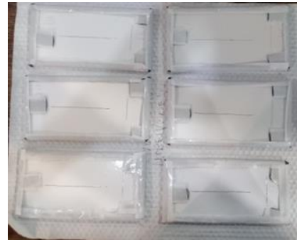
Figura 4. Incisión, en forma de T, sobre una de las caras de las probetas. Previo a introducirlas en la cámara de niebla salina.
