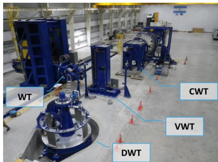
Figura 5. Instalación Centro de Soldadura por Fricción – Centro Espacial Punta Indio.
