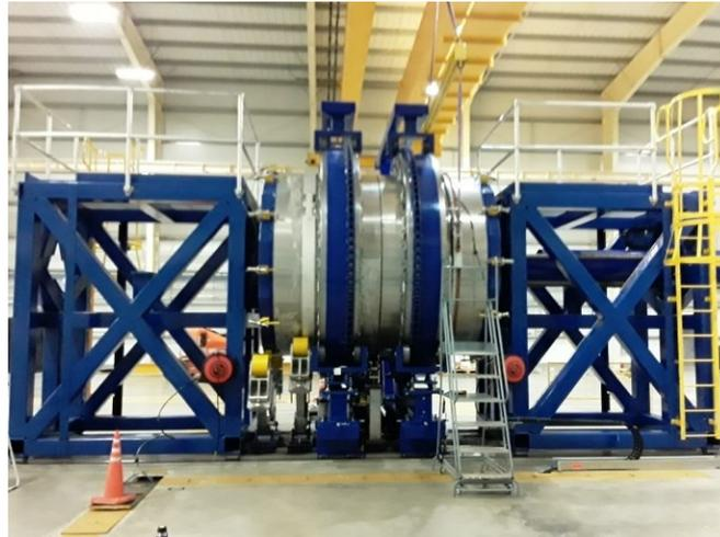
**Figura 9.** Estación de soldadura circunferencial (CWT) en proceso de armado de junta.
