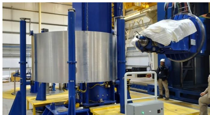
**Figura 8.** Estación de soldadura vertical (VWT) con una envuelta completa recién soldada.
