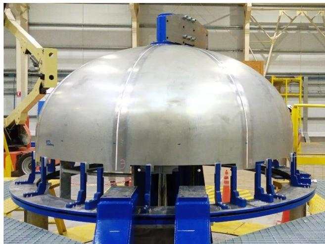
**Figura 10.** Estación de soldadura de domos (DWT) con un domo recién soldado.
