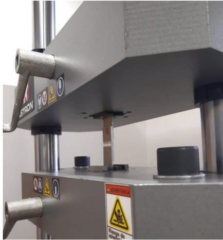
**Figura 22.** Ensayo de tracción en probeta de junta solapada – espesor total 5.6mm en Al2219-T81/T62.
