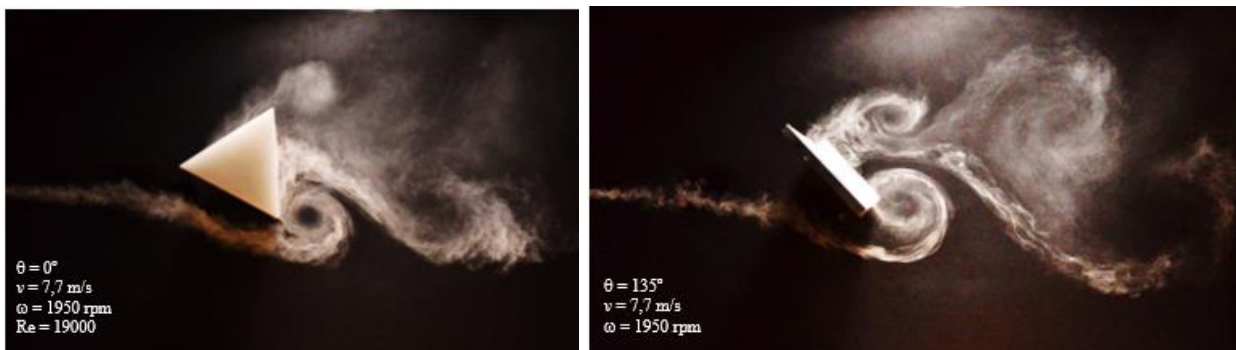
Figura 7 – Ejemplos de resultados de ensayo de visualización de un cuerpo cilíndrico de sección triangular y otro de una placa plana.
