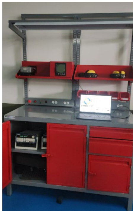
Figura 2. Banco de pruebas digital para la inspección auditiva de las bujías,
