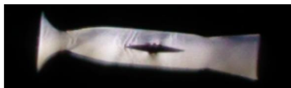
Figura 14. Visualización del Método Schlieren con perfil cuña de 7° con 0° de ángulo de ataque
