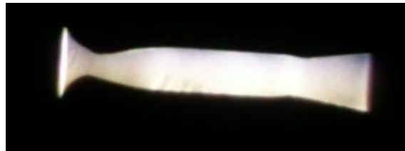
Figura 11. Visualización de Sección de prueba mediante método Schlieren en “reposo”
